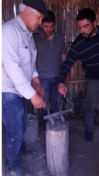
**Imagen 7.** “Cunita” herramienta para el armado y atado de paquetes.
